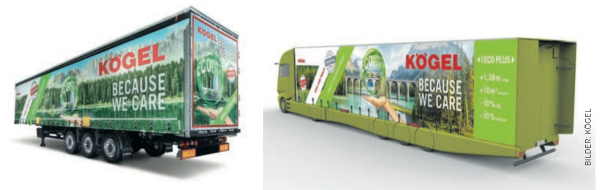
Links der Cargo Rail, rechts die Vision des Euro Trailers Concept 2030 mit Vollverkleidung.
